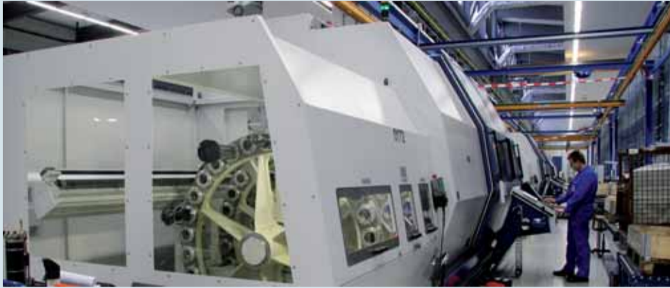
Das neue Produktionscenter verfügt über vier Millturn CNC Dreh-Bohr-Fräszentren des Typs M 65.
